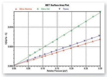
200m²/g硅钼样品 (红色),50m²/g硅 胶(绿色)与200m²/ g二氧化钛(蓝色)的 BET比表面积图显示 了TriStar II的多功能 性。三种不同的材料 可同时分析并进行比 对。
