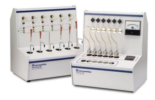
VacPrep™ 061提供两种方式除污染物。除了流动气体法外,它提供通过加热和抽的真空法制备样品。这种设计可使用户根据自己的材料或者应用选择合适的制备方法。VacPrep有六个脱气站,每个站都可选真空制备或流动气体制备。针阀设计使气体流动缓慢,防置样品被吹走。
