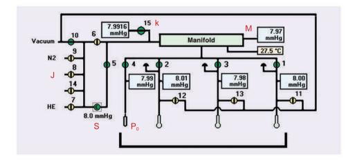
TriStar II具有四个进气口(J)。典型的配置是氮气作为分析气体,氦气用作为确定样品管自由空间。但是额外的二个进气口提供了更大的便利性。例如,二氧化碳通常用于较难分析的微孔材料,氦气可用于低表面积的样品(需要氦气分析选项-K)。
