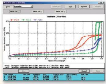
分析进程示例-TriStar II內置微处理器控制仪器操作并进行样品分析。这种用户友好的视窗和软件使用户可在工作区控制仪器,监控分析过程并查看实验结果。
